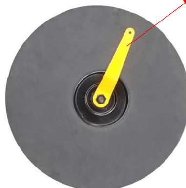
Fig. 11b Herramienta para ajuste de tuerca
