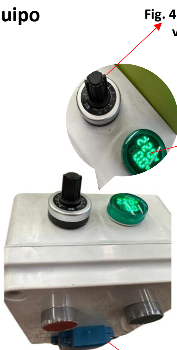
Fig. 4f Toma para conexión de herramientas externas
