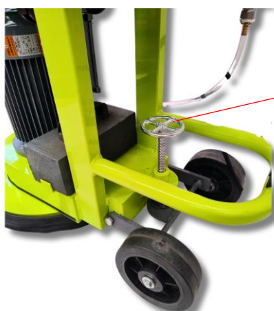
Fig. 7 Soporte de apoyo y regulación de ruedas
